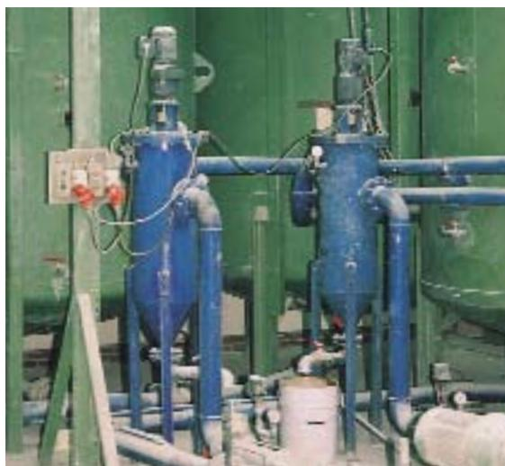
*Автоматический кромочный щелевой фильтр со скребковой очисткой для фильтрации клеев и адгезивов.*
