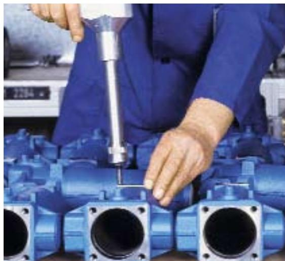
*Серийная сборка компонентов автоматических фильтров MAHLE.*
